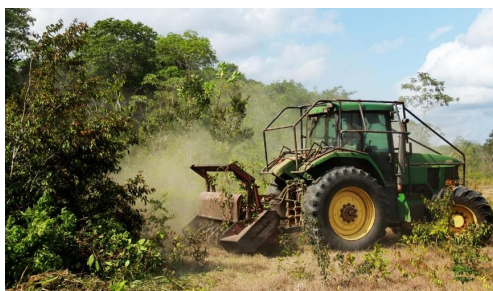
Figure 1 : Broyeur de bois de cerf AHWI, FM 600 ou Tritucap horizontal, écrasant la zone expérimentale, capoeira de cinq ans dans la commune d'Igarapé-Açu/PA.
